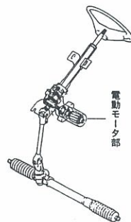
図4 コラムアシストタイプの電動パワーステアリング部
