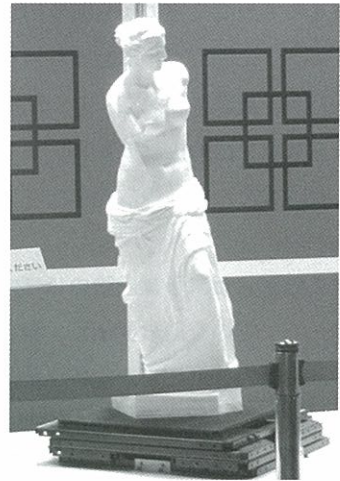
図4 美術品を守る免震装置(模型)
