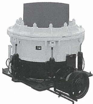
図2 二次破碎機（コーンクラッシャー）
