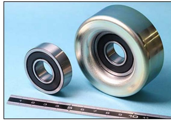
冷時異音の発生を抑えます。さらに、軸受の破損原因のひとつである脆性はく離に対し、破損の進行を抑制するグリース添加剤の採用や、軸受軌道輪の熱処理の工夫により、低温特性を向上しながら耐脆性はく離特性を維持しています。同時に、シール形状やグリース基油、軸受の内部諸元を最適化することで、シールにかかるトルクとグリースの搅拌抵抗を抑え、回転トルクも従来品と比べて10%低減を実現しました。
