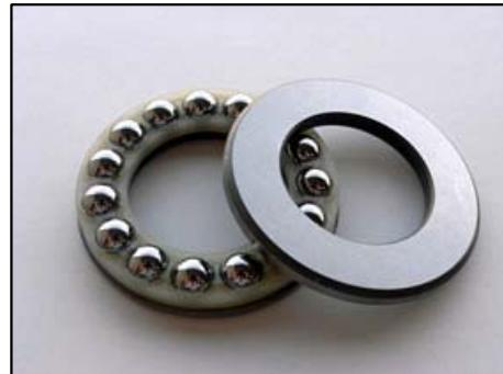
本製品は、内部疲労に強い高清浄度軸受鋼（EP鋼）と表面疲労に強い特殊熱処理、加えて繰り返し応力に強い材料を使用した保持器により、従来品の2倍以上の長寿命化を可能にしました。
