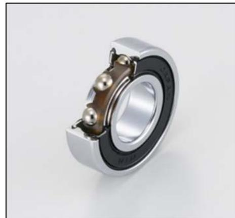
が低下する原因となります。これを防ぐために、サーボモータ本体に密封装置(シール)が用いられていますが、その分、サーボモータが大きくなり、小型化できないという課題がありました。そこで、密封装置無しでも付着を抑制するよう、低発塵の軸受が求められています。また、サーボモータの高出力化を図るため、低トルク化への要求も年々高まっています。今回開発した「サーボモータ用低発塵軸受」は、サーボモータで広く使用されている密封形深溝玉軸受に、発塵を抑制するための成分や配合を用いた新開発の低発塵グリースを封入しています。また、形状の改良により、内輪との摺動部の接触力を均一にすることで、密封性を高めるとともに、低トルク化を実現した新設計の接触形シールを採用しています。これにより、従来品に比べて、軸受からの発塵量を約 90% 低減するとともに、回転トルクを約 50% 低減しました。
