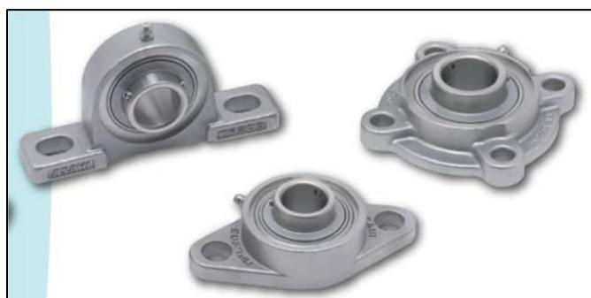
はマルテンサイト系ステンレス鋼に比べて硬さが劣ります。つまり、この 2 つの一般的なステンレス鋼において『耐食性と硬さは、両立し得ない トレードオフの関係』でした。そこで、新たな熱処理技術によって耐食性と硬さを兼ね備えた HNT 热処理鋼をインサート軸受に採用した新シリーズ「高耐食軸受」を開発しました。これにより、軸受寿命を大幅にのばすことができ、省エネ・省資源化に貢献します。また食品機械用グリース (NSF H1 認証品) を封入しているため、ステンレス鋳鋼製の軸受箱に組み込むことで、食品機械にも安心してご使用いただけます。
