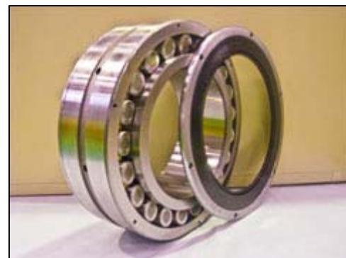
本製品は、独自の長寿命材料技術によって軸受内部をコンパクトに設計することで、シールスペースを確保しながら従来品と同一寸法で同等以上の負荷容量を実現しています。また、ボルト締結型シールホルダーによってシールの取り外しが可能となっており、設備組付け時にすきま測定ができるようになっています。これにより、異物侵入による早期損傷を防止するとともに、設備組付け時に適切なすきま管理を高精度に行うことが可能となりました。
