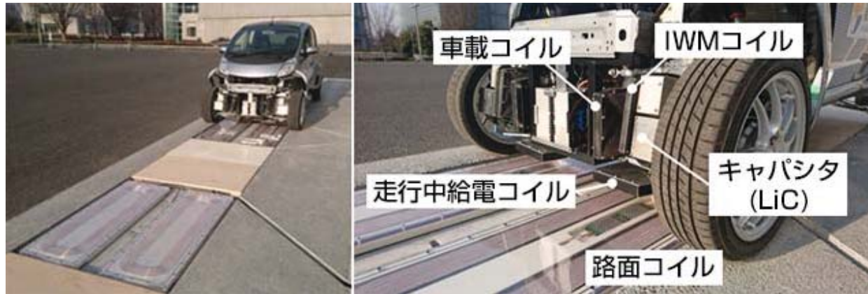
図1 走行中給電を行なう「第2世代ワイヤレスインホイールモータ」 (写真提供:東京大学大学院 新領域創成科学研究科 堀・藤本研究室)
