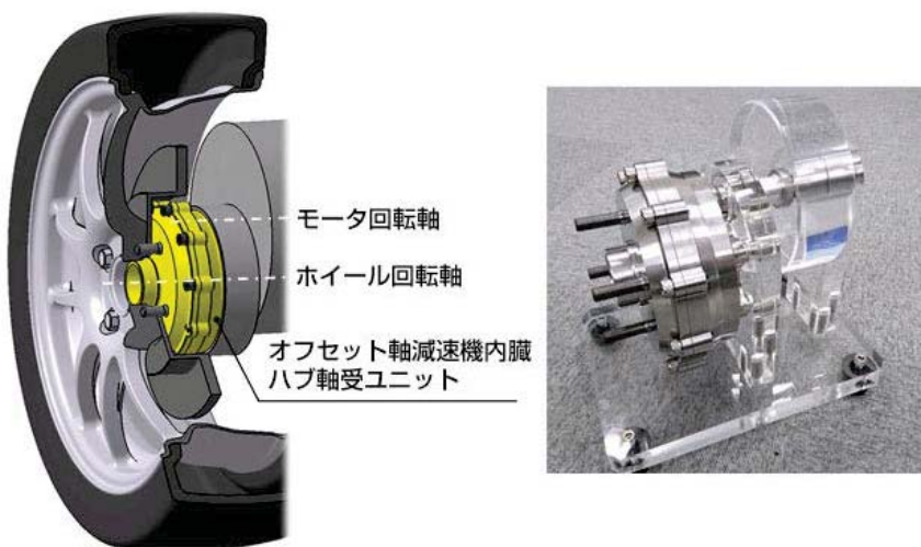
図1 オフセット軸減速機内蔵ハブ軸受ユニット
